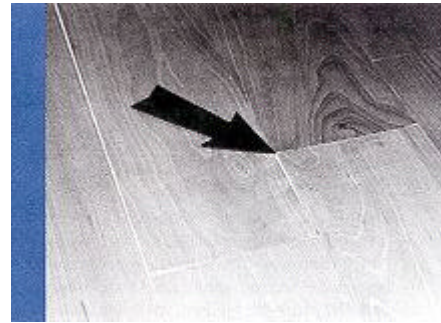
Abbildung 2 Zudem lösen sich die Deckschichten infolge eines Kohäsionsbruches der Leimfuge von der Stäbchenmittellage.
