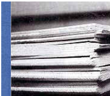
Abbildung 3 Fertigparkett-Böden verformen sich nicht nur erheblich, sondern tragen auch mechanische Schäden davon.
